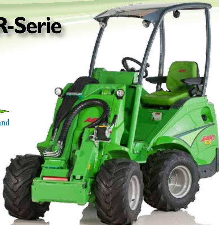
Die neue AVANT R-Serie unterscheidet sich durch die veränderte Lenkungsart von den Modellen der AVANT 200-700 Serien: Im Gegensatz zu diesen sitzt der Fahrer der R-Serie auf dem Hinterwagen.
