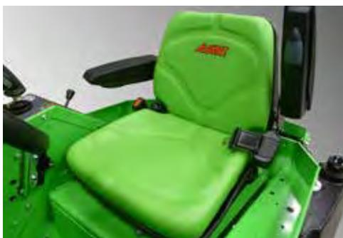
Il sedile ammortizzato è un optional sulla 200 e sulla 400 ed è dotato di cintura di sicurezza, braccioli e scaldia sedile.
