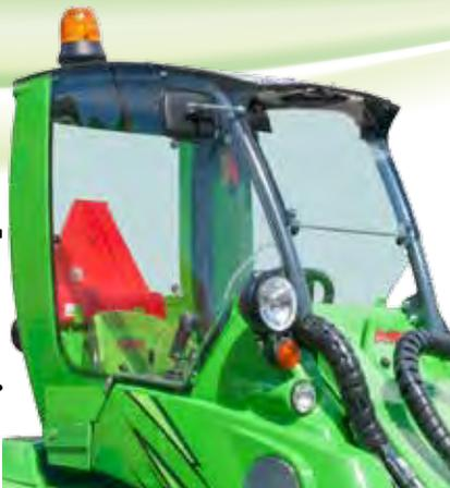
La cabina L è una scelta eccellente ed economica quando l'operatore vuole avere una protezione contro pioggia, vento e neve. Migliora il comfort dell'operatore considerevolmente. E' montata sul ROPS standard il che significa sicurezza garantita. Ha il parabrezza (dotato di tergicristallo e pompa acqua), plexy laterale destro e lunotto posteriore. La porta è disponibile solo per la cabina della serie 200 L.
