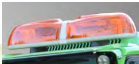
La barra lampeggiante si monta solo sulla cabina DLX, e si mette al posto si quello rotante.
