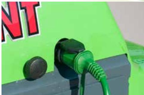
Lo scalda motore facilita l'accensione con temperature molto rigide, reduce il consumo di carburante e protegge le parti interne del motore.
