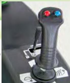
Il joistik a 6 funzioni permette di utilizzare le prese idrauliche anteriori tramite due bottoni e senza dover staccare la mano dalla manopola. In questo modo si velocizzano di molto le operazioni con accessory che richiedono un utilizzo frequente di idraulica... pinza insilati, forca con traslatore, braccetto scavatore ecc
