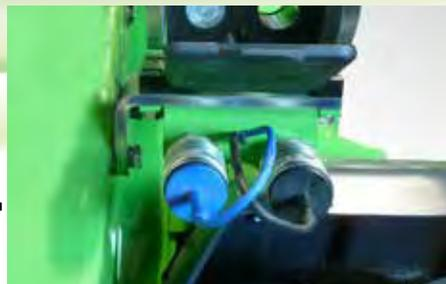
Escludendo gli attacchi posteriori la macchina può essere equipaggiata con un attacco anteriori doppio (andata e ritorno) che viene montato sotto il multiconnettore con due prese classiche. Vice versa se escludiamo l'attacco anteriore possiamo avere quello posteriore.
