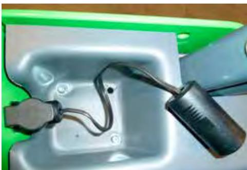
Cavo di collegamento, montato sulla presa 12V sul 300-700 serie e 200 serie 1. Dotato di un connettore in cui è possibile collegare la spina di un normale accendi sigari. Per esempio quando si utilizza un caricatore del telefono cellulare.
