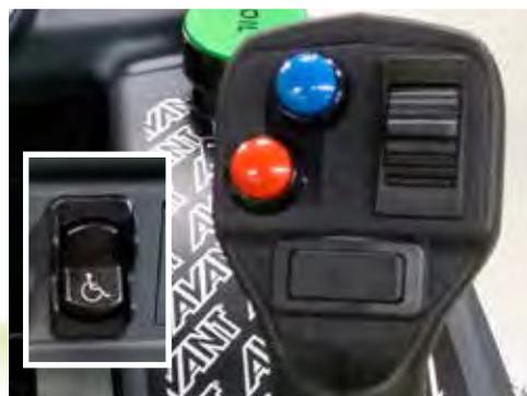
Il joistik per l'avanzamento manuale permette la conduzione avanti-indietro della minipala tramite un interruttore sul joystick, anziché utilizzare i pedali di marcia. L'avanzamento tramite il pulsante è proporzionale come con i pedali di marcia: più si preme e più si va veloci. È possibile utilizzare il joistik o i pedali di marcia standard, il tutto si decide tramite un interruttore sul cruscotto.
