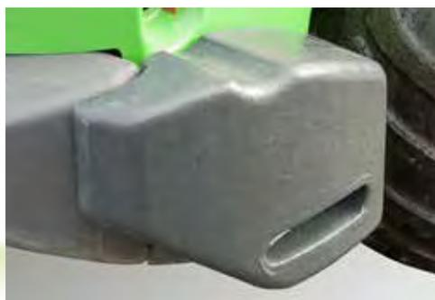
Si montano dietro le ruote posteriori e pesano 180 kg a coppia.
