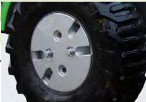
La serie avant 200 può essere equipaggiata con contrappesi da 14 kg montati sulle ruote con viti speciali. Abbassano il centro di gravità della macchina e aggiungono peso il che migliora la stabilità della macchina.
