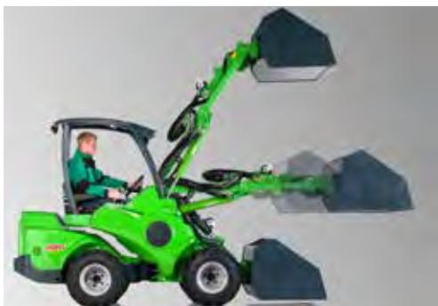
Il seistema autolivellante mantiene in parallelo l'accessorio indipendentemente da come tirate il joystick. L'autolivellante funziona idraulicamente tramite il cilindro che si trova a sinistra della macchina e lavora in compensazione con il cilindro della piastra di aggancio. Ideale con le forche pallet. L'autolivellante NON funziona se il sistema flottante è inserito.
