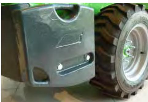
Le zavorre laterali si montano dietro le ruote posteriori sul telaio. Una a destra e una a sinistra. Il kit pesa 80 kg ed è principalmente indirizzato alla serie 400 ma va su tutte le altre serie.
