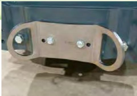
Il gancio di fissaggio posteriore facilita l'ancoraggio della macchina durante i trasposti.
