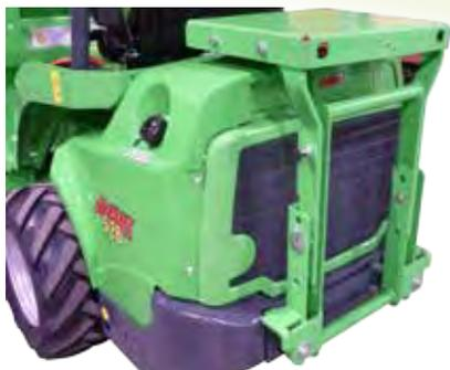
Il portapacchi posteriore è montato con delle viti sul paraurti. E' standard con il generatore, il compressore e la lancia di alta pressione.
