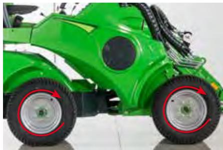
La valvola antislittamento devia l'olio tra i motori di destra e i motori di sinistra (forzando l'olio in maniera uniforme su entrambi i motori) migliorando la trazione su superfici scivolose e irregolari. La funzionalità della valvola dipende dal bloccaggio differenziale: se il bloccaggio è chiuso l'antislittamento devia il flusso su tutte le 4 ruote, se è aperto lo devia solo su quelle anteriori.
