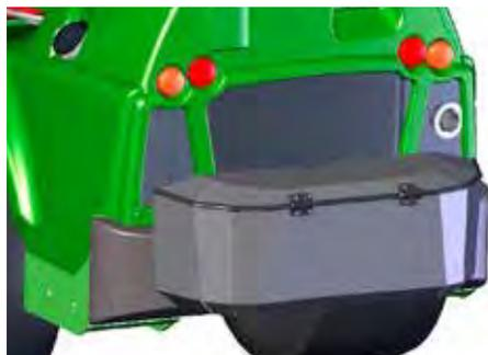
La cassetta degli attrezzi con serratura montata sul paraurti posteriore.
