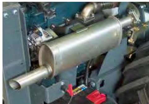
Il depuratore di scarico può essere montato al posto della marmitta standard. Riduce le emissioni dei motori diesel.
