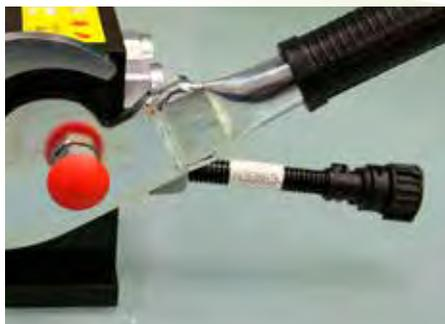
Sulle macchine prodotte prima del 2016 dove il connettore non era integrato nel Faster si può avere un cavo di adattamento per renderlo uguale alle macchine attuali. Si monta dal vecchio cavo e si arriva direttamente nel faster in modo da avere tutto il blocco integrato. Esiste anche la modifica per il cavo dell'accessorio ovviamente.
