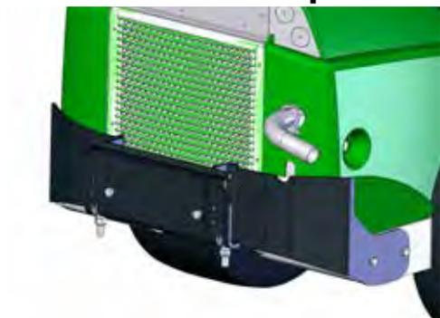
É possibile montare e trasportare accessori posteriormente con questa piastra ma la zavorra standard da 170kg va tolta e le zavorre laterali non possono essere montate.
