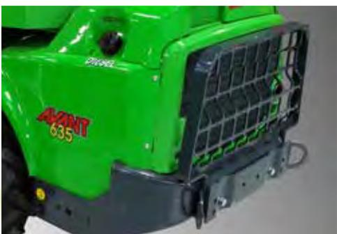
La rete protegge il radiatore del motore. E' montata con 4 viti ed è facile da installare. La rete puo essere montata anche se ci sono le zavorre posteriori e il gancio traino.
