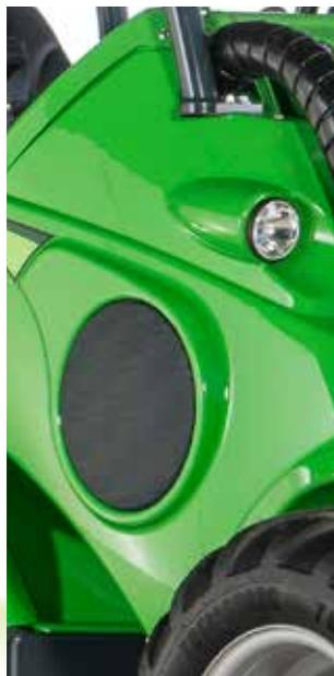
Le carene HD sono realizzate in policarbonato antiurto con grande resistenza agli urti. Possono prendere delle botte in cantiere e sono anche resistenti se saltate su di loro. Le carene HD sono lucide come le carene standard.
