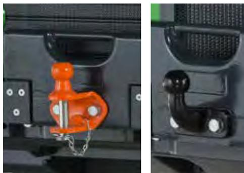
Ci sono due tipi di ganci di traino disponibili: uno sferico da 50 mm e un combinato da 50 mm con perno di traino e sfera. Entrambi possono essere montati direttamente sul paraurti posteriore o sulla zavorra posteriore da 29 kg. Solo Avant serie 200 è equipaggiata di serie con un gancio sfera 50 mm .
