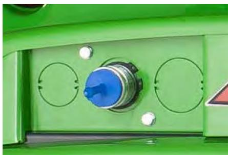
Attacco idraulico posteriore singolo. Rende possibile l'utilizzo degli accessori con una sigola funzione.
