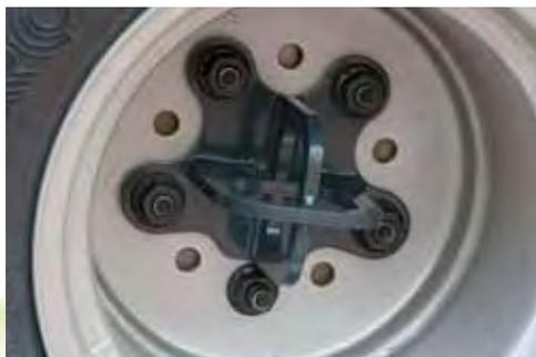
Questa staffa facilita il fissaggio della macchina durante i trasporti. Va su ruote a 5 o 10 fori.
