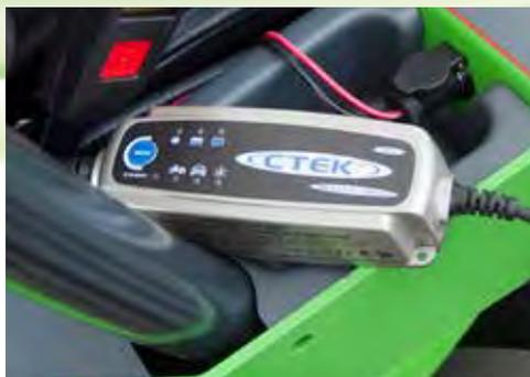
Il caricabatterie va collegato alla presa 12V della macchina, il che rende la ricarica della batteria molto semplice perché non c'è bisogno di togliere le carene, al fine di raggiungere i poli della batteria. Il caricabatterie è automatico - cambia automaticamente dalla carica alla modalità manutenzione.
