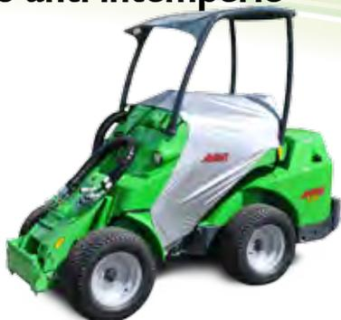
Il telo anti intemperie protegge il posto di guida contro pioggia, neve, polvere e sporcizia. Il telo intemperie copre l'intera plancia, volante e sedile del conducente. Il telo viene fornito con una sacca integrata in cui può essere avvolto quando non in uso.
