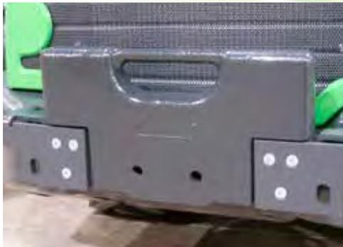
LA zavorra etra a valigetta pesa 29 kg ed è dotata di maniglia per poterla spostare comodamente. Si aggancia facilmente al paraurti posteriori. Soi possono attaccare fino a cinque zavorre. I ganci traino A417323 e A417337 si montano facilmente sulla zavorra.
