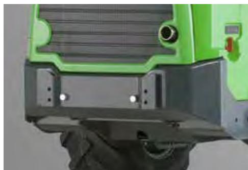
Avant 500 e 600 è equipaggiata con una zavorra standard di 170 kg. Se necessitate di una macchina più leggera per dei lavori su solai o su terreni delicati il paraurti può essere montato al posto della zavorra integrata riducendo il peso della macchina di 150 kg.
