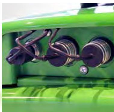
Für den Betrieb doppelwirkender Anbaugeräte wie z.B. Kreiselegge ist diese Heck-Zusatzhydraulik erforderlich. Die doppelwirkende Zusatzhydraulik ist mit einer Druck- und einer Rücklaufleitung ausgestattet (in der AVANT 400-700 Serie zusätzlich mit einem drucklosen Rücklauf), und macht den Einsatz von im Heck montierten doppelwirkenden Anbaugeräten möglich, z.B. Sandstreuer etc. Bei der Ausstattung des Laders mit der optionalen Handsteuerung ist keine doppelwirkende Heck-Zusatzhydraulik möglich.
