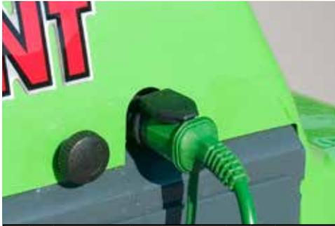
Der Motorvorwärmer erleichtert das Starten des Laders bei Umgebungstemperaturen im Minusbereich und reduziert gleichzeitig Kraftstoffverbrauch und Schadstoffausstoß.
