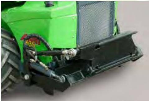
Einige Anbaugeräte (Streuer, Bodenfräse etc.) können bei Bedarf auch am Heck des Radladers montiert werden. So kann gleichzeitig eine Schaufel oder ein Schneeschild an der Front des Laders betrieben werden. Die Heckaushebung, ist mit einer doppelwirkenden Heck-Zusatzhydraulik ausgestattet.
