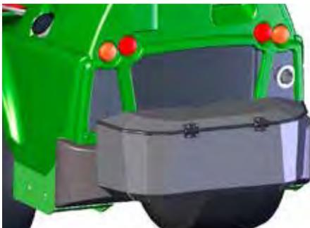
Box für Aufbewahrung und Transport von Werkzeug, Ausrüstung etc., die auf die Stoßstange im Heck der Maschine aufgeschraubt ist. Der Deckel kann bei Bedarf abgeschlossen werden.
