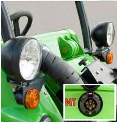
Das Paket beinhaltet Scheinwerfer, Blinker, Rundumleuchte, Reflektoren, einen Spiegel und das Warndreieck im Heck der Maschine. Das Kommunalpaket ist normalerweise eine Voraussetzung zur Erteilung einer Straßenzulassung, bitten nehmen Sie Kontakt mit Ihrem Avant-Händler.
