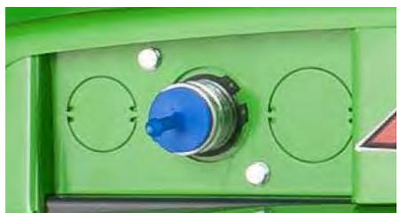
Für den Betrieb einfachwirkender Anbaugeräte wie z.B. Reitbahnplaner oder Kippanhänger ist die Heck-Zusatzhydraulik erforderlich. Die einfachwirkende Zusatzhydraulik ist mit einer Druckleitung ausgestattet und macht den Einsatz von im Heck montierten einfachwirkenden Anbaugeräten möglich.
