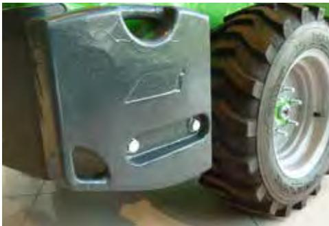
Das 80 kg Heck-Seitengewicht-Set besteht aus 2 je 40 kg schweren Heck-Seitengewichten, die rechts und links vom Lader montiert werden. Das 80 kg-Set ist speziell für die kleineren AVANT-Serien konstruiert, kann aber auch an den größeren AVANT-Modellen verwendet werden. Die Gewichte steigern Hubkraft und Stabilität beim Umgang mit schweren Lasten.
