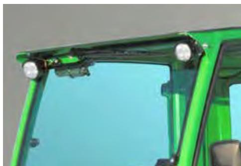
Die zusätzlichen LED-Arbeitsscheinwerfer ermöglichen den sicheren und effizienten Einsatz des Laders auch bei Dunkelheit und können auch an einer Leichtkabine LX montiert werden. Sie haben die Wahl zwischen LED-Scheinwerfern mit 700 Lumen oder 2500 Lumen. Die 3 Leuchten werden im Front-(2) und Heckbereich (1) montiert.
