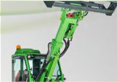
Mit dem Teleskophubarm heben Sie Lasten höher und erreichen auch schwerer zugängliche Arbeitsbereiche. Der Teleskophubarm erlaubt mehr Flexibilität bei allen Ladevorgängen: stufenloses und exaktes Ein- und Ausfahren des Hubarmes, ohne den Lader bewegen zu müssen. Die Bedienung erfolgt über den Bedienhebel im Armaturenbrett. Die Modelle der 500 - 700 Serie sowie der e- und R-Serie sind serienmäßig mit dem Teleskophubarm ausgestattet.
