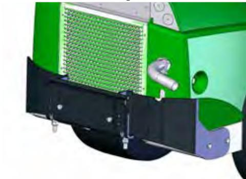
Ermöglicht die Montage und den Transport von Anbaugeräten im Heck. Das serienmäßige 170 kg Heckgewicht mit der Stoßstange muss entfernt werden und es können keine Heckgewichte, Heck-Seitengewicht-Sets oder Anhängerkupplungen verwendet werden.
