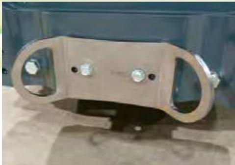
Eine einfache Zurröse zum schnellen Verzurren Ihres Laders beim Transport. Die Zurröse kann entweder im Heck oder seitlich hinten am Lader montiert werden; darüber hinaus ist auch die Montage zwischen Heck und Anhängerkupplung möglich. So kann die Zurröse auch mit montierter Anhängerkupplung verwendet werden.
