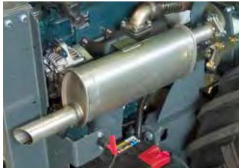
Der Abgas-Katalysator ersetzt den Originalschalldämpfer und ist Katalysator, Schalldämpfer und Funkenfänger in einem.
