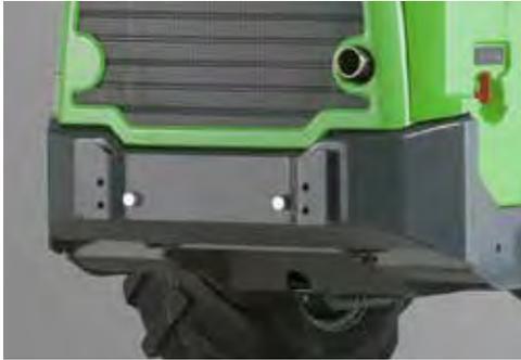
Die AVANT 500- und 600-Serie kann bei Bedarf anstelle des serienmäßigen 170 kg Heckgewichtes mit einer leichten Stoßstange ausgestattet werden. Dies reduziert das Gewicht um ca. 150 kg, was auf empfindlichem Untergrund oder bei eingeschränkter Tragfähigkeit des Untergrundes nützlich sein kann.
