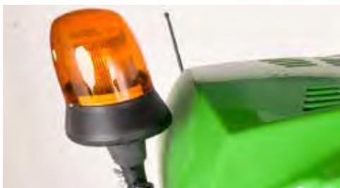
Die Rundumleuchte ist mit einer sehr hellen Xenon-Lampe ausgestattet. Sie wird auf einem kippbaren Sockel installiert und ist leicht an- und abzubauen.
