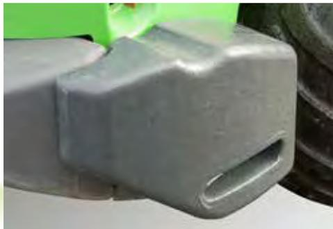
Das 180 kg Heck-Seitengewicht-Set besteht aus 2 je 90 kg schweren Heck-Seitengewichten, die rechts und links hinter den Hinterrädern des Laders montiert werden. Die Gewichte steigern Hubkraft und Stabilität beim Umgang mit schweren Lasten.
