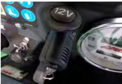
Der Adapterstecker wird am 12V-Anschluß des Laders angeschlossen. Die elektrische Leitungen von einem 12V Elektrogerät, z. B. ein Batterieladegerät, können im Stecker eingekuppelt werden.
