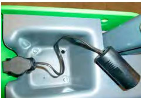
Anschlusskabel, montiert an der 12V-Steckdose der 300-700 Serie und 200 Serie(I). Ausgestattet mit einem Stecker, an dem ein Zigarettenanzünder angeschlossen werden kann, zum Beispiel bei der Verwendung eines Handy-Ladegerätes.
