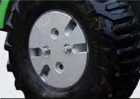
Die AVANT 200 Serie kann mit 14 kg schweren Radgewichten ausgerüstet werden, die mit speziellen Bolzen an der Felge montiert werden. Sie halten den Schwerpunkt des Laders tief und erhöhen die Stabilität besonders in unebenem Terrain oder in Waldgebieten.
