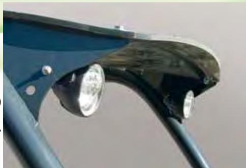
Die zusätzlichen LED-Arbeitsscheinwerfer ermöglichen den sicheren und effizienten Einsatz des Laders auch bei Dunkelheit. Sie haben die Wahl zwischen LED-Scheinwerfern mit 700 Lumen oder 2500 Lumen. Die 3 Leuchten werden im Front-(2) und Heckbereich (1) montiert.
