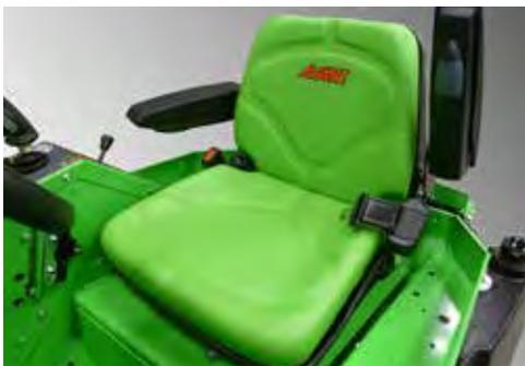
Der gefederter Sitz ist optional für die AVANT 200- und 400 Serie erhältlich und ausgestattet mit Armlehnen, Sicherheitsgurt und Sitzheizung.
