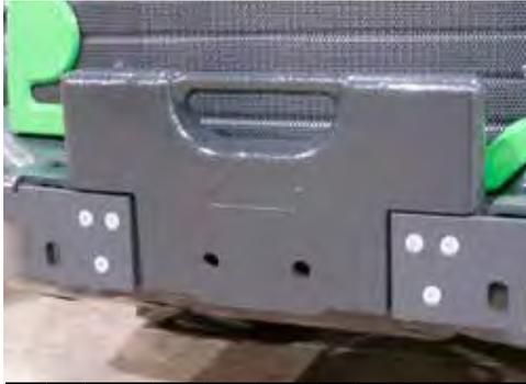
Das 29 kg schwere Heck-Zusatzgewicht mit Griff sorgt bei schwerer Beladung des Laders für zusätzliche Stabilität und ist mit den Befestigungshaken leicht an- und abzubauen. Die beiden ebenfalls optional erhältlichen Anhängerkupplungen können in das Zusatzgewicht integriert werden
