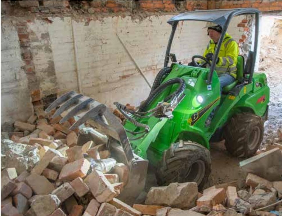
AVANT e5 und e6 sind voll elektrische, batteriebetriebene Multifunktionslader mit Knickgelenk - perfekt geeignet für den Einsatz in Innenräumen, nicht belüfteten Räumen und überall dort wo Abgas- oder Lärmrestriktionen gelten.
